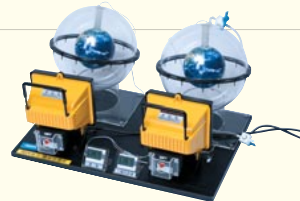
地球儀を囲む容器は一方に空気を、もう一方にCO 2 を封入。ハロゲンライトで加熱して温度をチェックし、上昇率の違いを確認する実験で、地球温暖化のイメージを子どもたちにわかりやすく伝える
